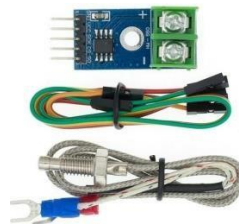
Gambar 5. MAX6675 Type K (Sumber : Kuncoro dkk., 2023)
