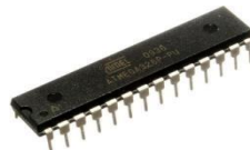
Gambar 3. ATmega328 (Sumber : Chandra dkk., 2022)
